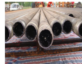
Состояние трубок и плунжеров после 300 дней эксплуатации
